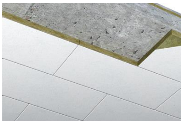
Figura 8.4– Esempio di isolamento del solaio di copertura
